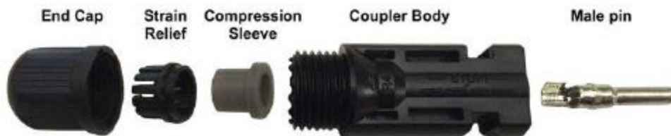
Figura 31 Conector de un MC4 negativo.
